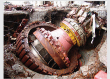
▲ 17 АВГУСТА 2009 ГОДА НА САЯНО-ШУШЕНСКОЙ ГЭС В РЕЗУЛЬТАТЕ АВАРИИ МНОГОЭТАЖНОГО ГИДРОАГРЕГАТА БЫЛ ЧАСТИЧНО РАЗРУШЕН И ЗАТОПЛЕН МАШИННЫЙ ЗАЛ. АВАРИЯ ПРИВЕЛА К ЧЕЛОВЕЧЕСКИМ ЖЕРТВАМ. В ХОДЕ СОВМЕСТНЫХ УСИЛИЙ УДАЛОСЬ СПАСТИ ЛЮДЕЙ, ОПЕРАТИВНО ОРГАНИЗОВАТЬ АВАРИЙНЫЙ ВОДОСВРОС, ВОССТАНОВИТЬ ЗАТВОРЫ, ОТКАЧАТЬ ВОДУ И РАСЧИСТИТЬ ОТ ЗАВАЛОВ МАШИННЫЙ ЗАЛ.
